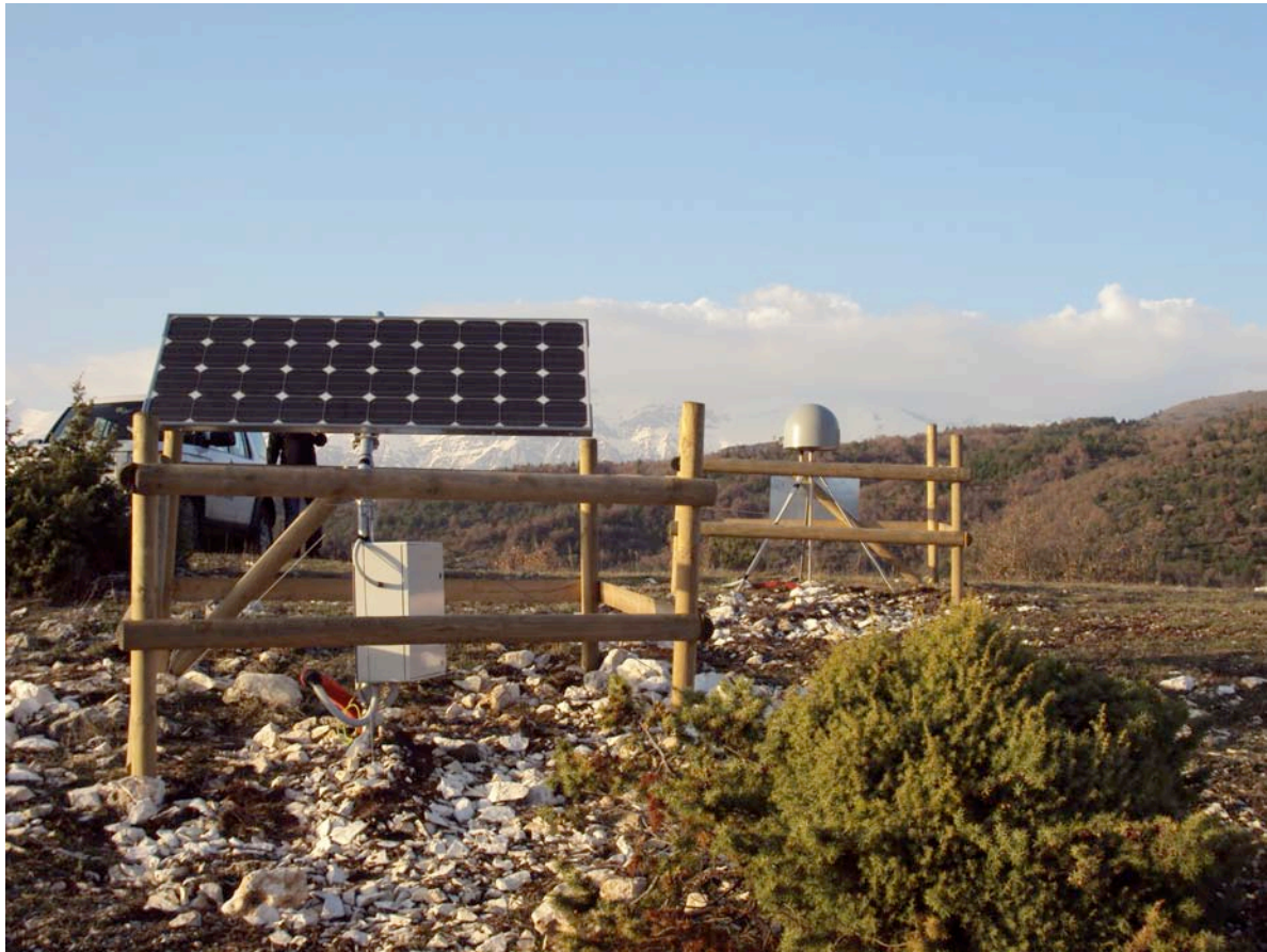
Figura 7. Stazione GPS permanente di San Gregorio (SGRE) a seguito dell’ottimizzazione del sito.
