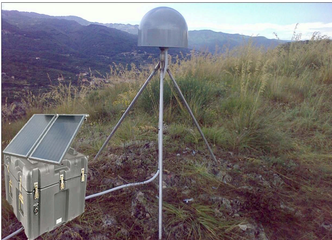
Figura 11. Simulazione di installazione di una futura stazione GPS permanente di pronto intervento.
