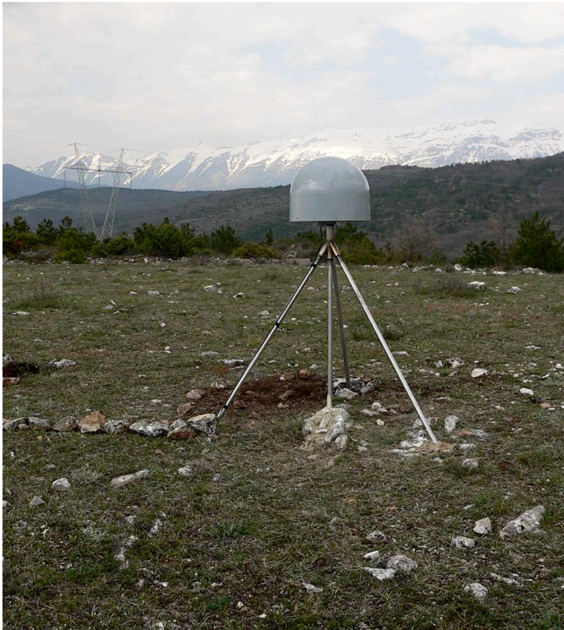
Figura 3. Monumento short-drilled-braced installato sulla stazione di San Gregorio (SGRE) il 7 aprile 2009.
