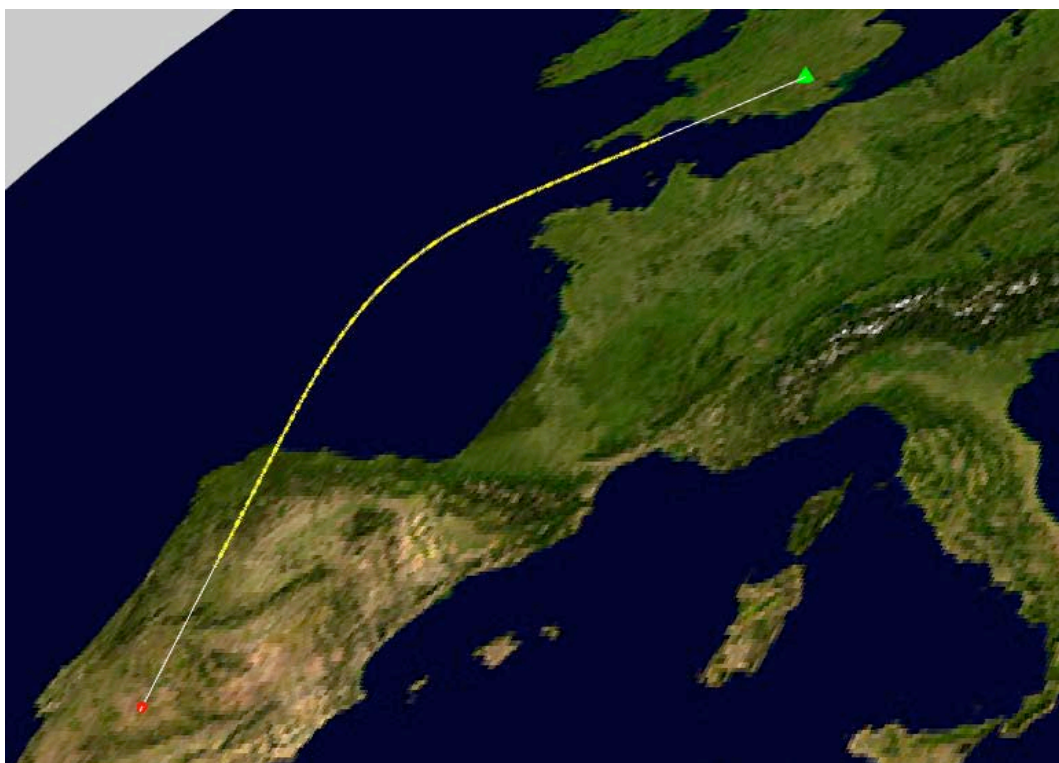
Figura 6. Visualizzazione in 3D di un raggio partito dall’Osservatorio di Greenwich (51.4772° - N 0° E) a Frequenza 11 MHz, Elevazione 15° e Azimut 200°. La parte evidenziata in giallo rappresenta il cammino del raggio nella ionosfera (errore relativo sulle coordinate geografiche di 10^{-4} ).
