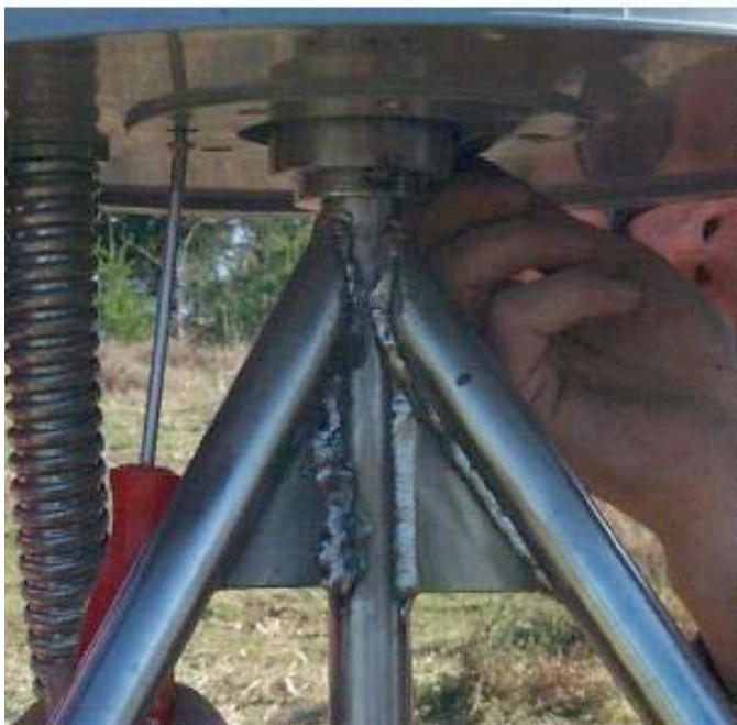
Figura 2. a) Particolare delle sezioni delle 3 aste laterali; b) Particolare delle aste laterali tripode short-drilled-braced superficiale modello “Wyatt/Agnew” (versione 1).
