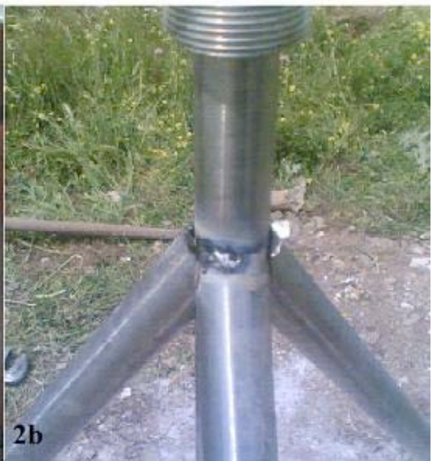
Figura 2. a) Particolare delle sezioni delle 3 aste laterali; b) Particolare delle aste laterali tripode short-drilled-braced superficiale modello “Wyatt/Agnew” (versione 1).
