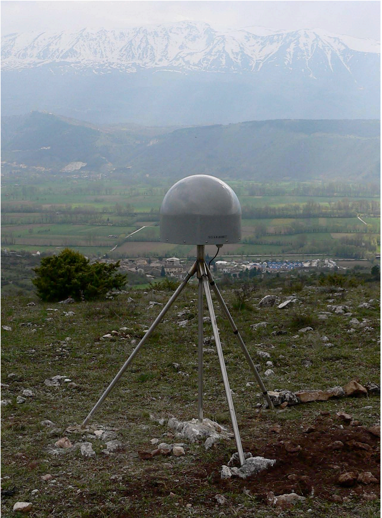
Figura 9. Esempio di monumentazione con il nuovo adattatore tripode.
