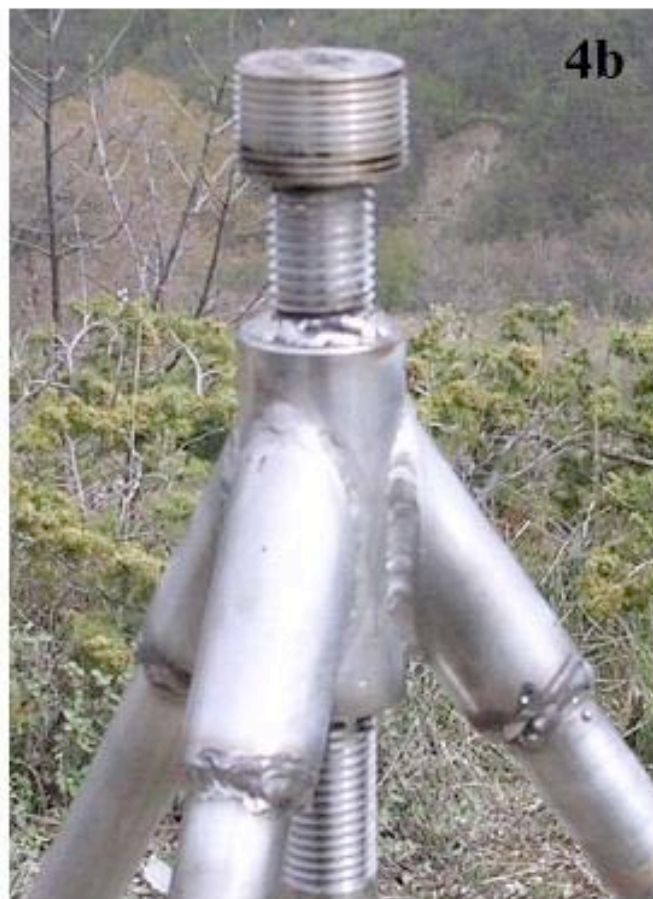
Figura 4. a) Progetto del raccordo tra aste laterali e asta centrale e dell'anello adattatore filettato del tripode superficiale modello D'Ambrosio (versione 2); b) Foto dell'adattatore tripode e dell'anello adattatore assemblati.
