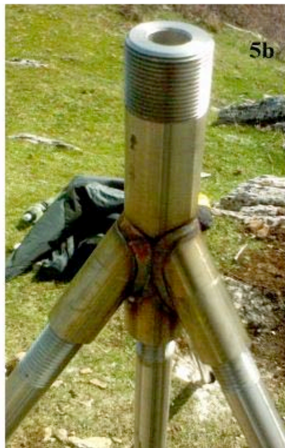
Figura 5. a) Progetto del nuovo tipo di adattatore tripode progettato per migliorare ulteriormente la realizzazione di monumenti tipo short-drilled-braced 4EVO (versione 3); b) Foto del nuovo adattatore tripode.
