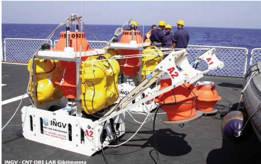
**Figura 5** Un OBS/H realizzato presso l’Osservatorio di Gibilmanna - CNT.
