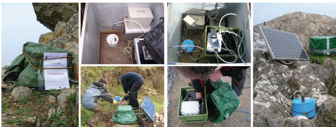
**Figura 4** Esempi d’installazione di stazioni sismiche temporanee durante il progetto “Messina 1908-2008”.
