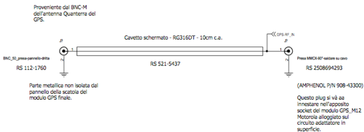
Figura 26: cavo RF – connessione ricevitore GPS con antenna attiva.
