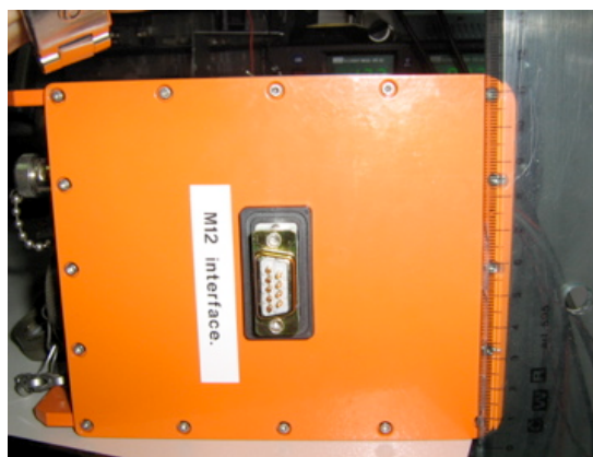
Figura 4: pannello laterale destro del Q330 (dopo la modifica).
