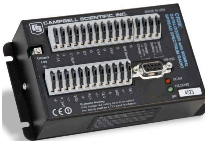
Figura 4. Il datalogger CR200 della stazione meteo.
