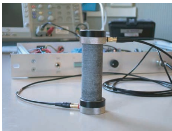
Figura 14 A sinistra i tre campioni di roccia utilizzati negli esperimenti di collaudo: da sinistra C3 (basalto), S5 (arenaria), T1 (milonite). A destra il campione di basalto attrezzato con i trasduttori. Figure 14 On the left, the three rock samples used in the experiments: from the left: C3 (basalt), S5 (sandstone), T1 (milonite). On the right a particular of the basalt sample equipped with the transducers.
