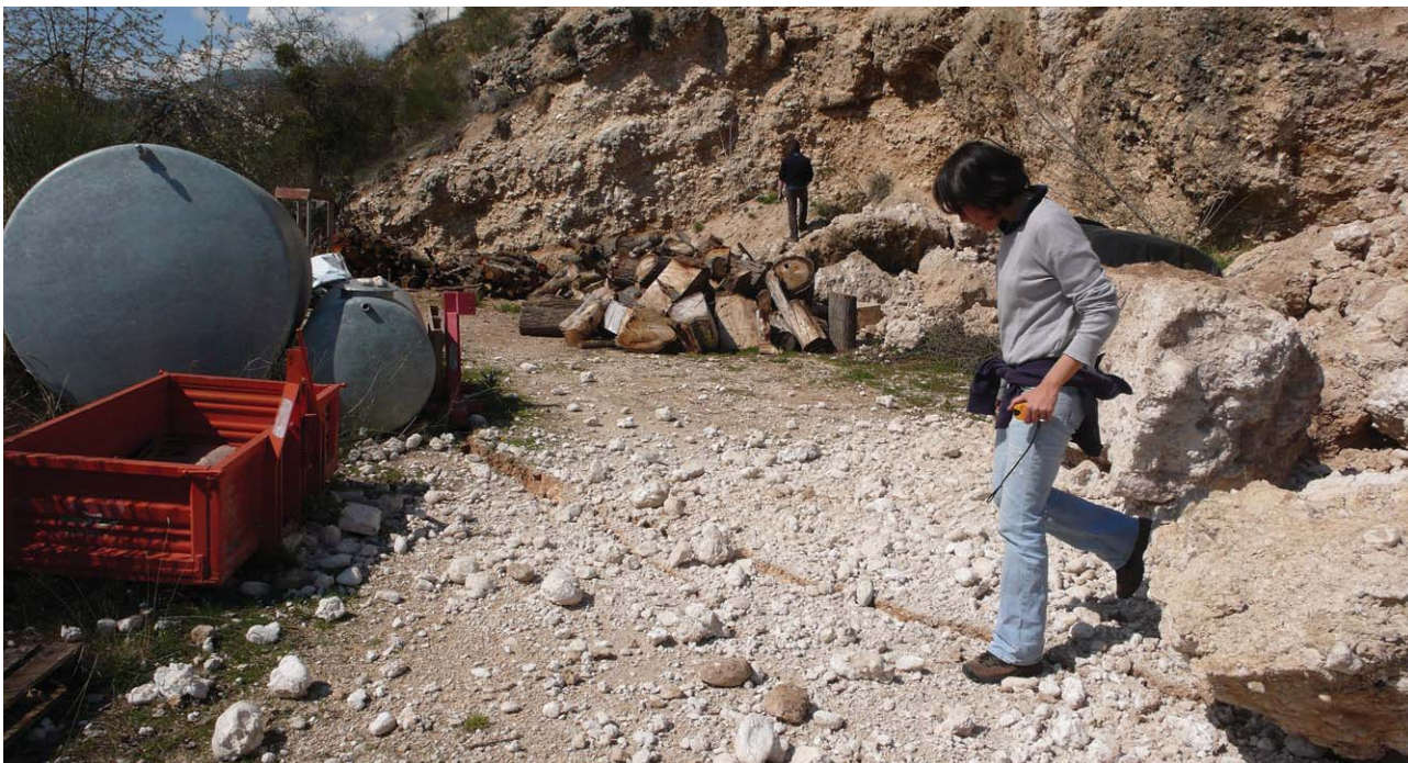
Figura 11 Frattura (rigetto verticale di circa 10 cm) che disloca il terreno presso Paganica. Figure 11 Rupture (vertical throw ~10 cm) displacing the ground near Paganica.
