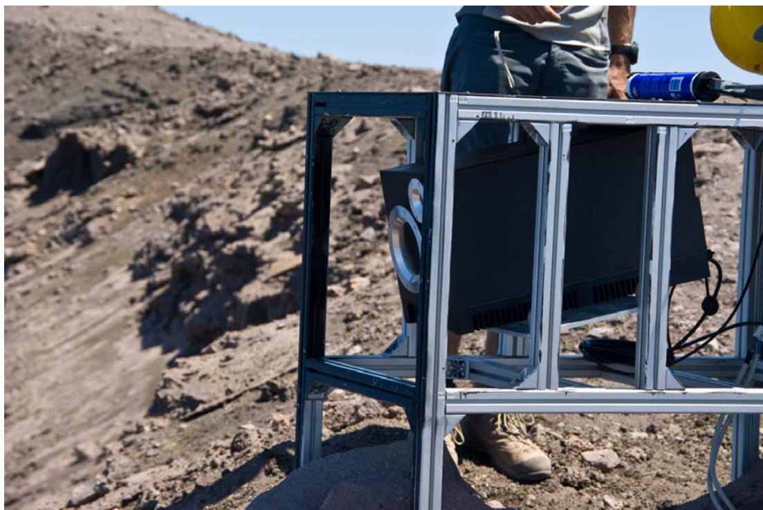
Figura 3- Stazione posta all'interno del box protettivo. Si notano le due differenti finestre (vedi testo).
