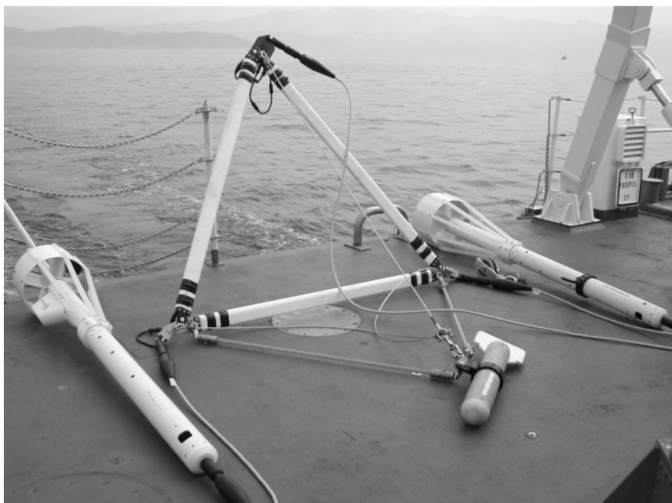
**Fig. 1** - L'apparato magneto-gradiometrico G-880.
