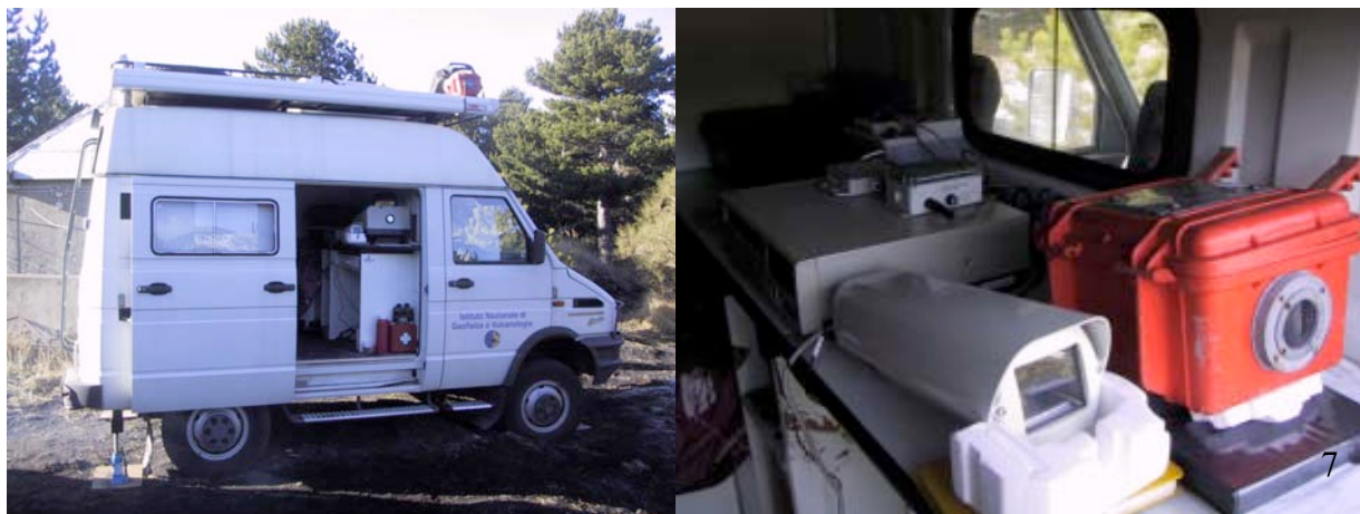
Figura 7. Mezzo mobile dell'Istituto Nazionale di Geofisica e Vulcanologia con all'interno la telecamera Sony FCB 470 LP, il videoregistratore time-lapse Panasonic AG 6040, l'FTIR ed il radiometro.
