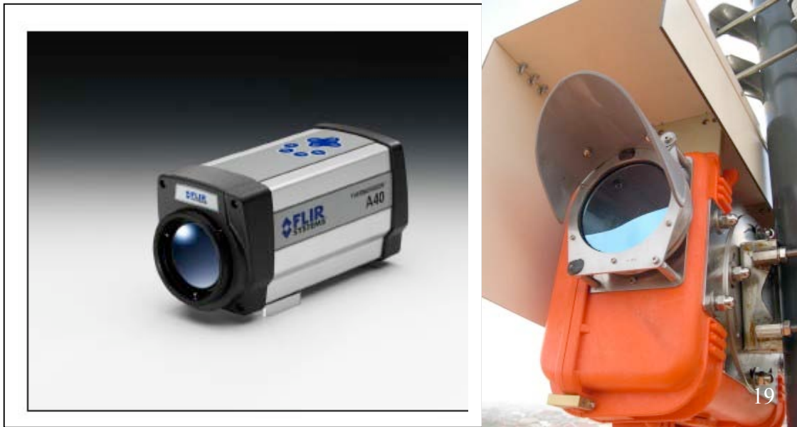
Figura 19. La telecamera termica Flir A 40 M ethernet e l'apposita custodia stagna installata a Nicolosi.
