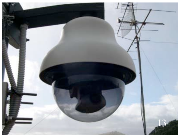
Figura 13. La telecamera Canon VC-C4R dentro l'apposita custodia stagna.
