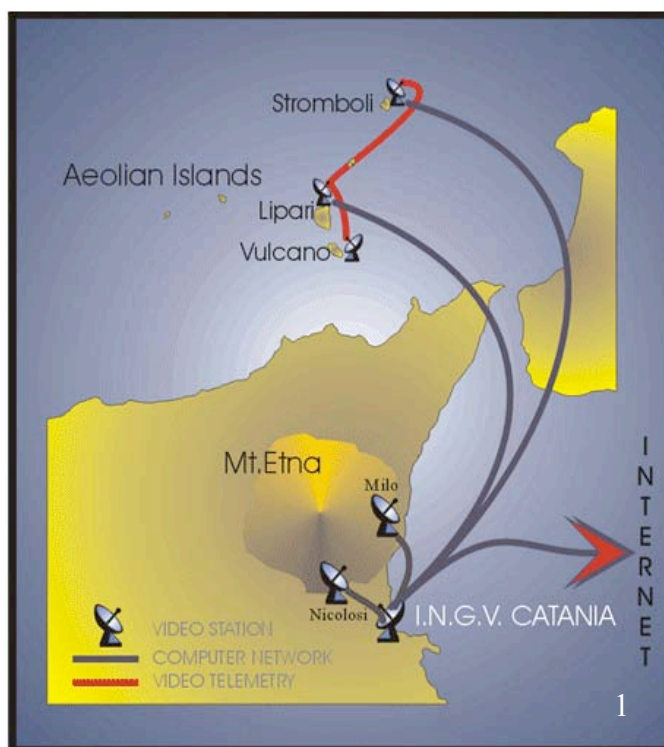
Figura 1. Stazioni di monitoraggio video installate sull'Etna e alle Eolie e trasmissione dei segnali televisivi al CUAD.
