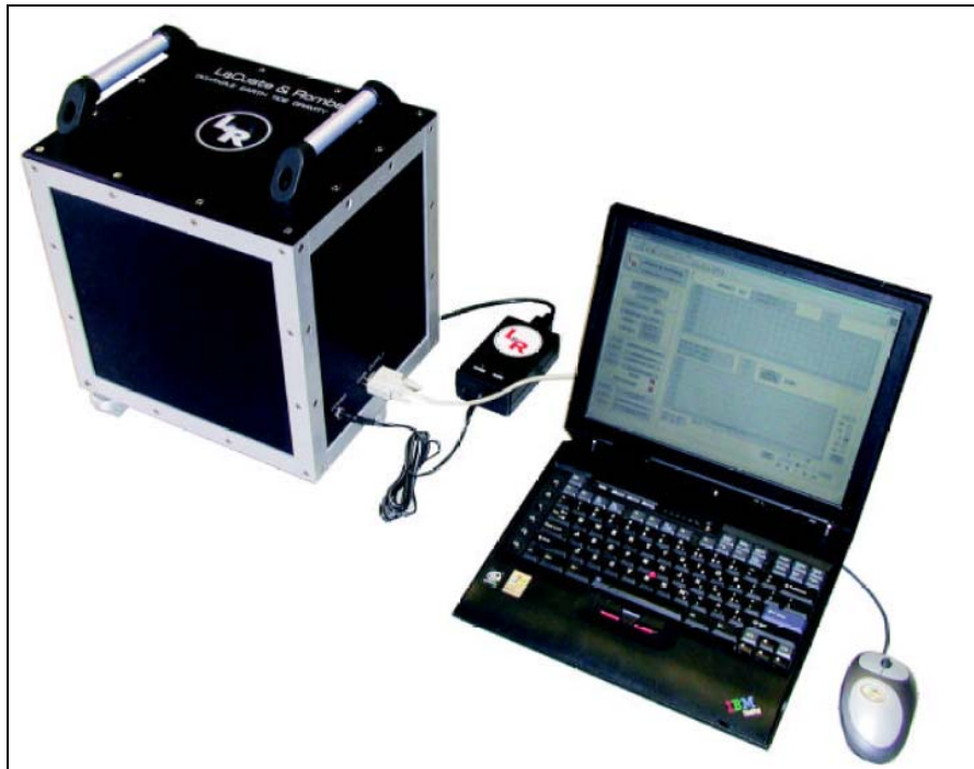
Figura 4. Il gravimetro PET con il relativo computer portatile per l'acquisizione delle misure.
