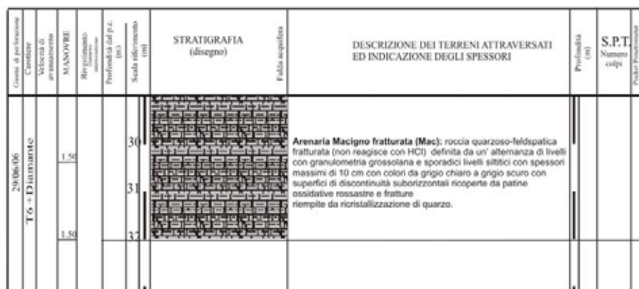
Figura 7.6.2.: profilo stratigrafico del sottosuolo (dati da Regione Toscana – Progetto VEL - finanziamento OPCM 3362/06).
