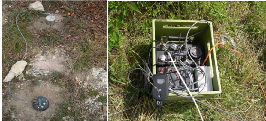
Figura 7 - A sinistra: sensori della rete temporanea (in basso il sensore accelerometrico). A destra: acquisitori Reftek 130 6 canali e sistema GPS integrato.
