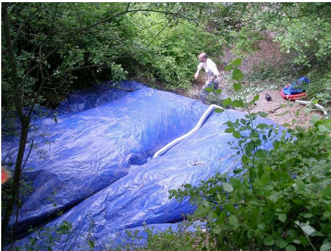
Foto 9. Sistema SAP completo, montato sulla polla Colle Monticchio in Val Comino e gonfiato “a regime” dal flusso gassoso emesso. A margine si notano i diversi set di tubi corrugati a diametro differente da utilizzare sulla base al flusso gassoso riscontrato in loco. (foto: C. Cardellini)
