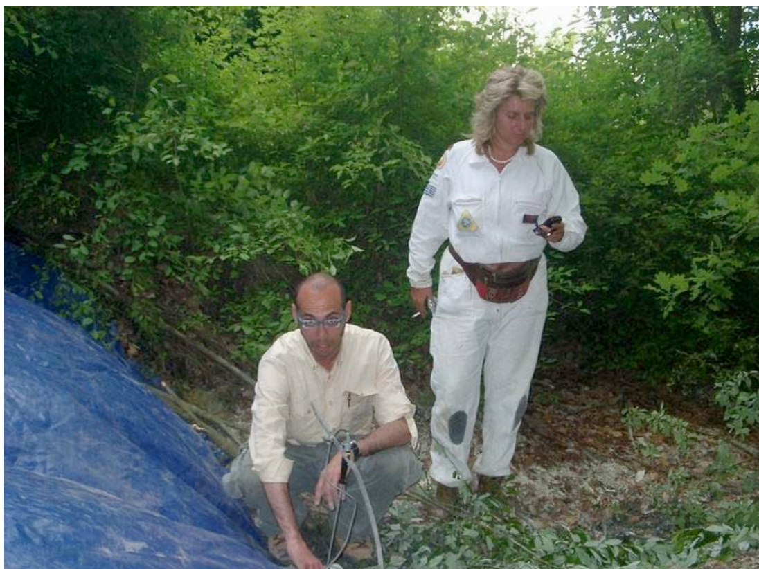
Foto 10. Collezionamento delle misure a margine della polla Colle Monticchio con il sistema in funzione. Il telone del SAP è completamente rigonfio per effetto della pressione esercitata dai gas in uscita. (foto: S. Mecozzi)
