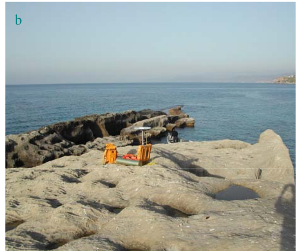
Fig. 13 - a) La rete GPS di Capo Vaticano – Monte Poro (VV e CV sono le faglie di Vibo Valentia e Capo Vaticano, più prossime ai siti archeologici; b) il ricevitore GPS in acquisizione allo Scoglio Galera nel corso dei rilievi geodetici.
