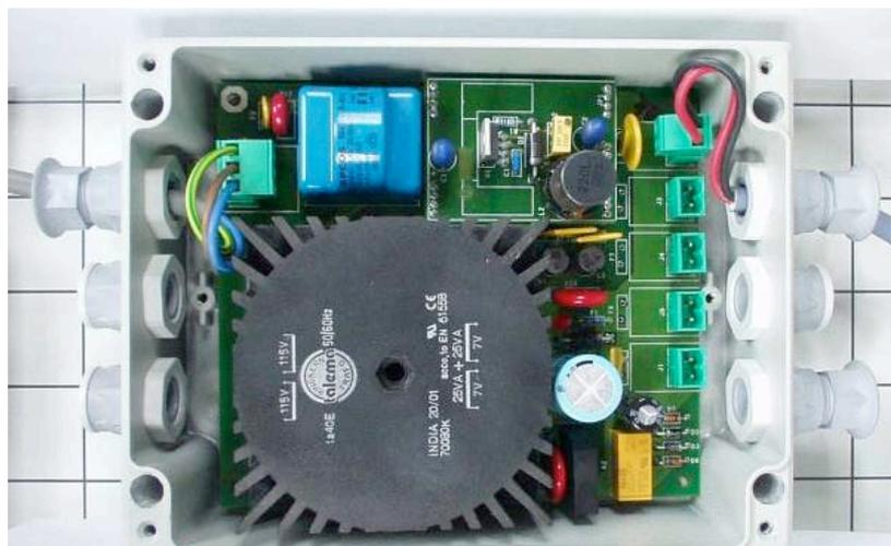
Figura 20: Particolare del Modulo ALIM1 inserito nel contenitore stagno in alluminio. Si possono notare i pressacavo a tenuta stagna e il grosso trasformatore toroidale di isolamento
