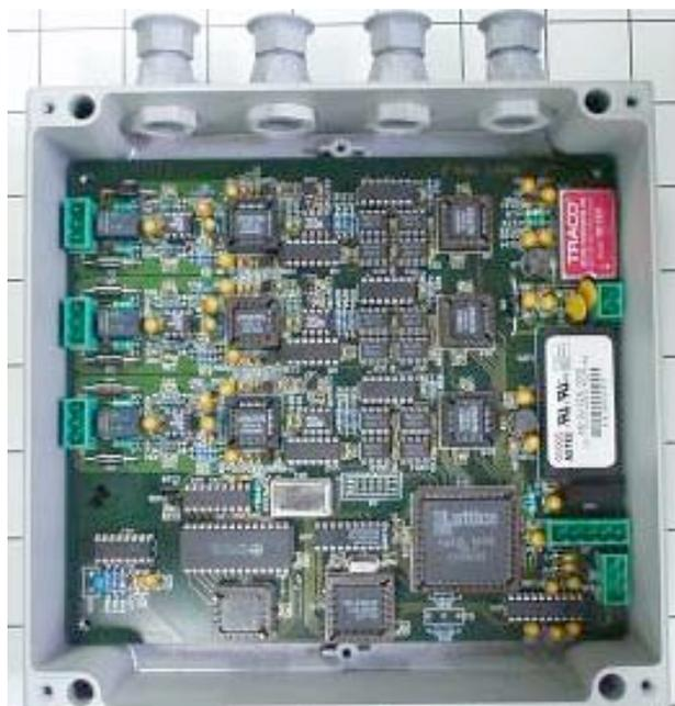
Figura 18: Particolare del Modulo AGDF1 inserito nel contenitore stagno in alluminio
