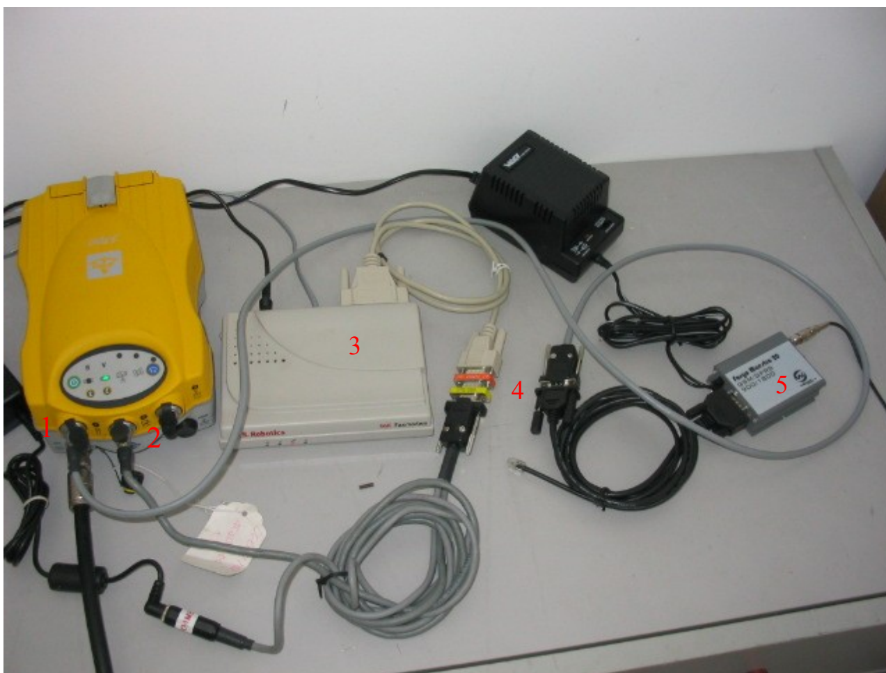
Fig. 9 – Esempio di connessione diretta modem-ricevitore Trimble 5700:
