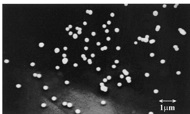
Figure III.3 : Image typique prise au Microscope Électronique à Balayage des particules solides contenues dans la fumée d'encens [ZUK 99]
