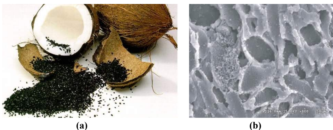
Figure 17 : Granulés de charbon actif fabriqué à partir de noix de coco (a) ; cliché de microscopie électronique à balayage de la structure d'un charbon actif (b).
