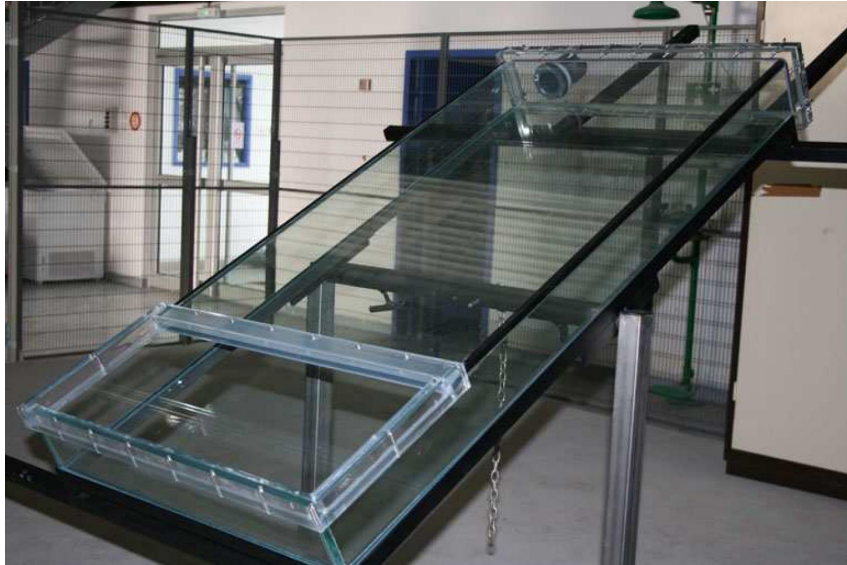
FIGURE V.1 – Cavité sur le support pivotant, sans instrumentation ni isolation.
