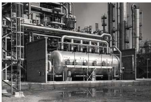
FIGURE 2: Exemple d'une cuve d'oxydation horizontale à cinq compartiments (procédé CYCLOPOL, Krzysztoforski et al. (1986), Pohorecki et al. (2009))
