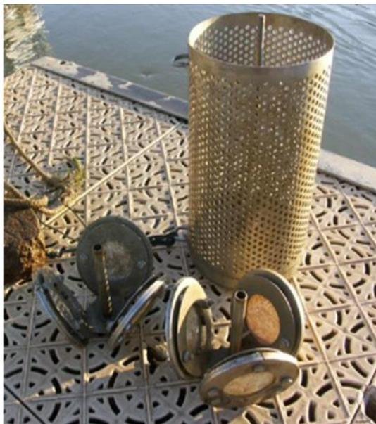
Figure 26. POCIS montés sur leurs supports (holder) et cage après exposition.
