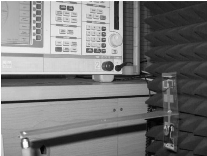
*Figure 4.22 - Mesure de l'impédance des prototypes HO-01 avec l'Analyseur de Réseau Vectoriel ZVB8 de Rohde & Schwarz*
