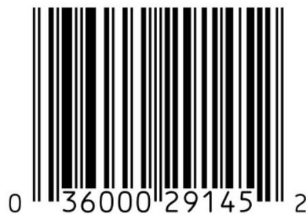
*Figure 1.4 - Un exemple de code à barres UPC [1.11]*
