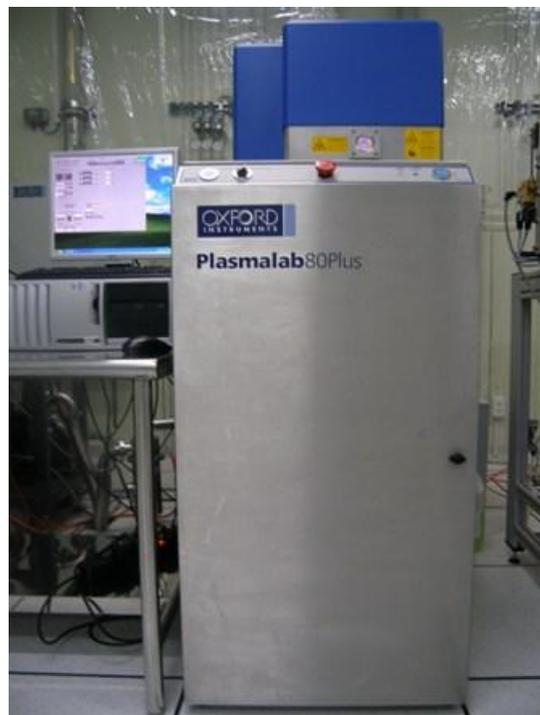
*Figure 3.2 – Equipement de gravure par ions réactifs Plasmalab80 +*
