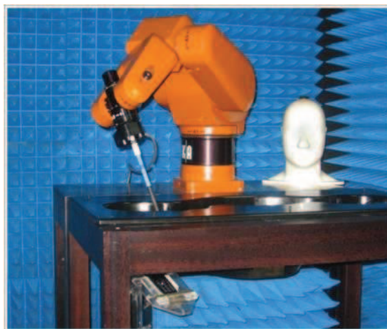
Figure I-3 : Banc de mesure de DAS en laboratoire.
