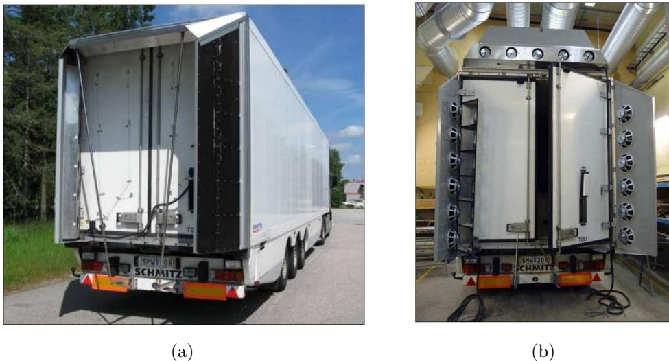
FIGURE I.63 – Photographies du système de contrôle par association entre des volets et des actionneurs jets synthétiques, d’après El-Alti et al. [42].
