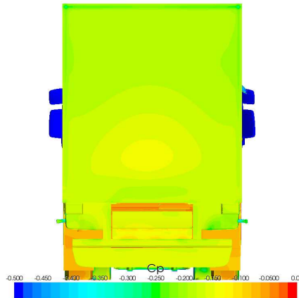
FIGURE I.13 – Cartographie du coefficient de pression statique au culot de la remorque, d’après Chacaton [23].
