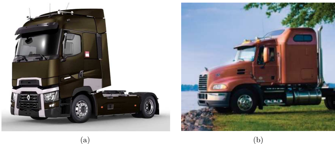
FIGURE I.14 – Photographies de cabine COE, le Renault Trucks Range T (a), et conventionnelle, le Mack Pinnacle (b), dans la gamme du groupe Volvo AB.
