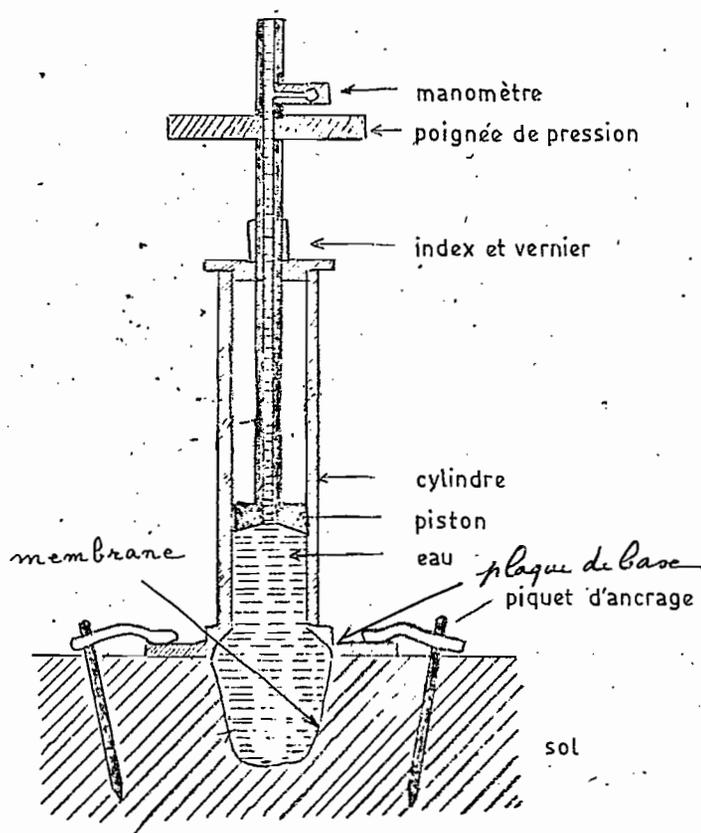
Figure n° 11 : Schéma du densitomètre à membrane.
