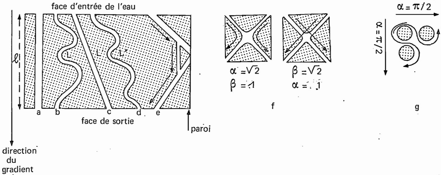
Figure n°41 : Tortuosité  $\alpha$  et obliquité  $\beta$  des tubes
