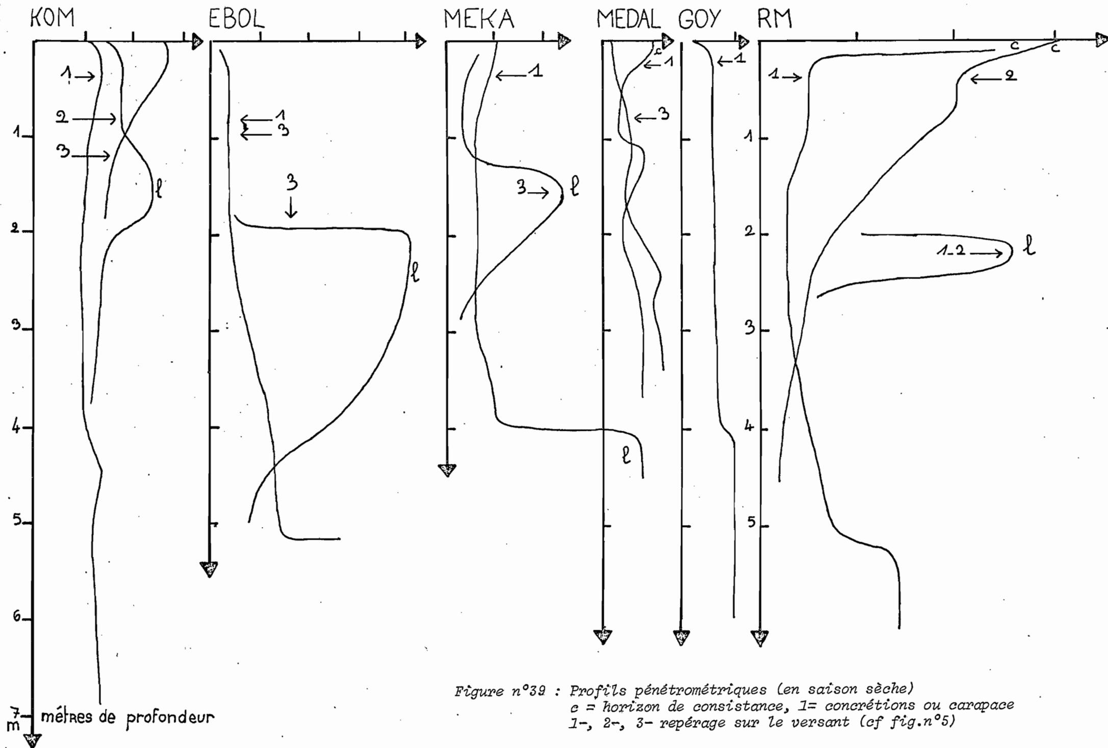
Figure n°39 : Profils pénétrométriques (en saison sèche)
