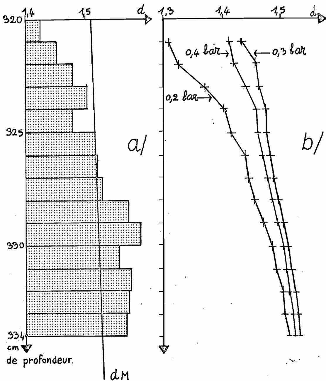
Figure n°38 : Modification des résultats de densité apparente par bombement et écrouissage des parois de la cavité ( $d_M$  = profil densimétrique moyen)
