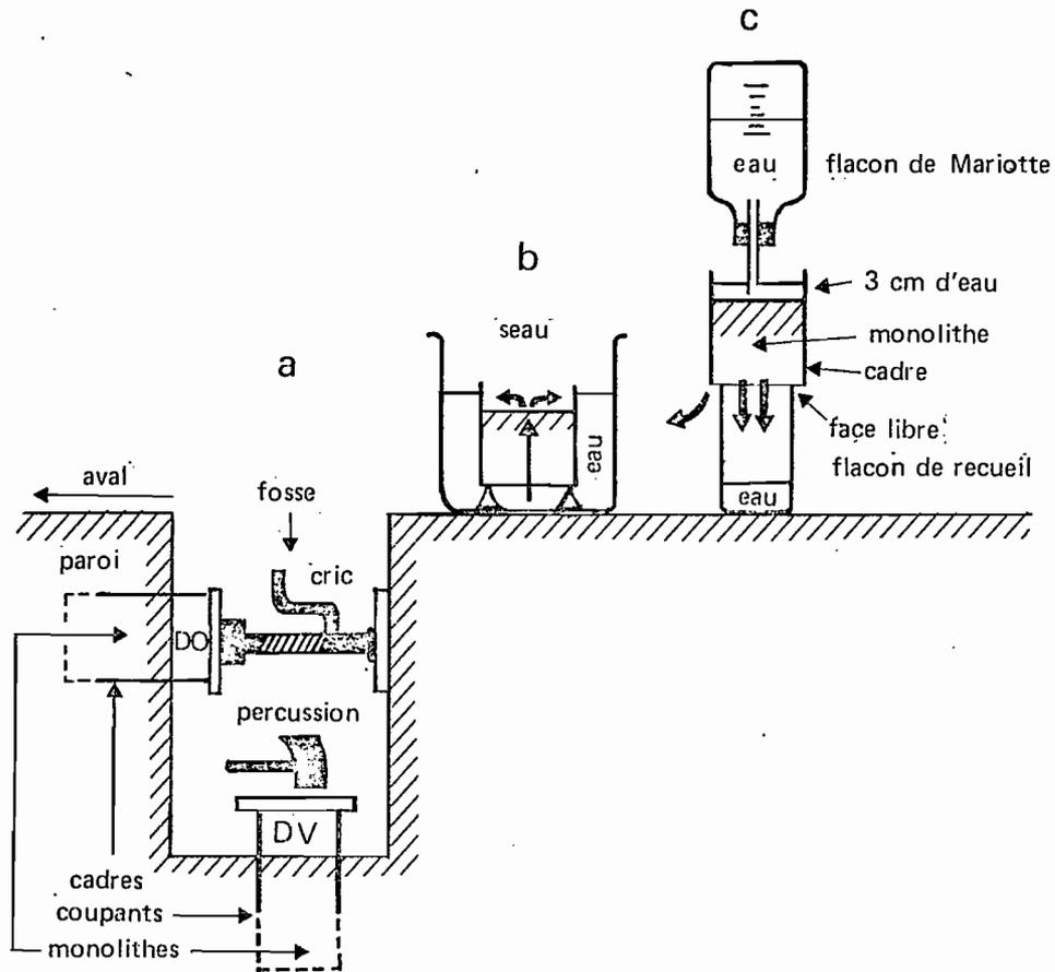
Figure n° 14 : Mesure des perméabilités directionnelles.
