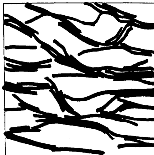
FIG. 17. — Mode de réorganisation d'un réseau de smectite Ca en fonction des conditions d'hydratation
