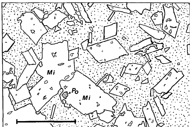
Fig. 6 — Amas sulfo-arsenié, faciès minéralisé massif Cristaux millimétriques de mispickel (Mi) dispersés dans une matrice de quartz-séricite, mispickel avec inclusion de pyrrhotite (Po) (lame mince polie, l'échelle représente 500 µm). Massive sulfide mineralization, central facies. Millimetric arsenopyrite aggregates and subhedral grains dispersed in a quartz-sericite matrix; poikilitic grain with pyrrhotite (Po) inclusion; (bar scale = 500 µm)
