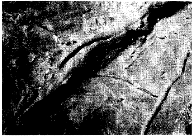
Photo d : surface grise, déferrifiée et empreintes racinaires d'une face de glissement. Horizon Gr d'un vertisol de versant Vv (prélèvement vers 70 cm)
