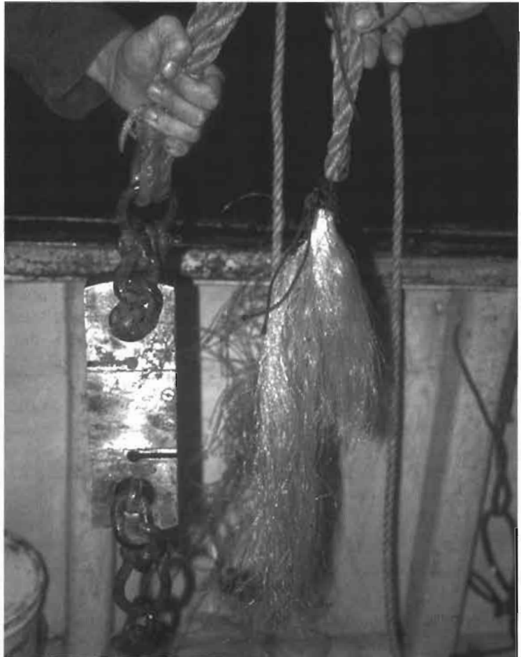
Photo 2 Cordage rompu par un navire à fort tirant d'eau.
