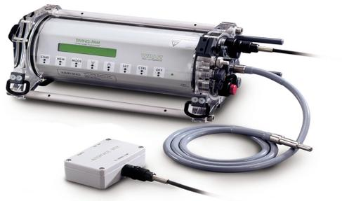
Figure 6 : Diving-PAM composé d'un caisson hermétique et d'une fibre optique permettant de soumettre les coraux à différentes irradiances et de mesurer en retour leur fluorescence
