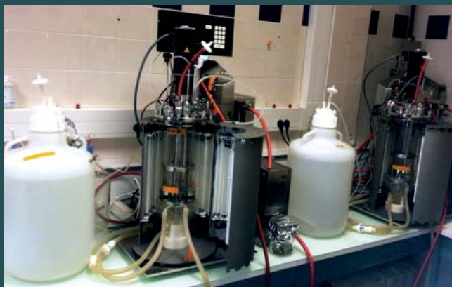
▲ Photobioréacteurs utilisés dans le cadre du projet ANR RHOMEO pour des mesures de rendement en carbone dans différentes conditions d'éclairement.
