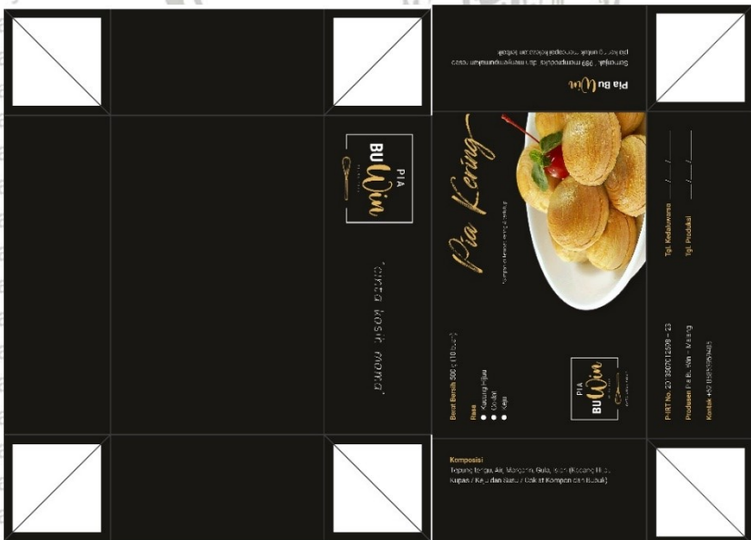
Gambar 4.6. Dieline Lengkap Kemasan Sekunder Kue Pia Bu Win
