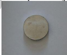
Рисунок 1 – Лигатура (а) в виде брикетов (б) после экструзии
