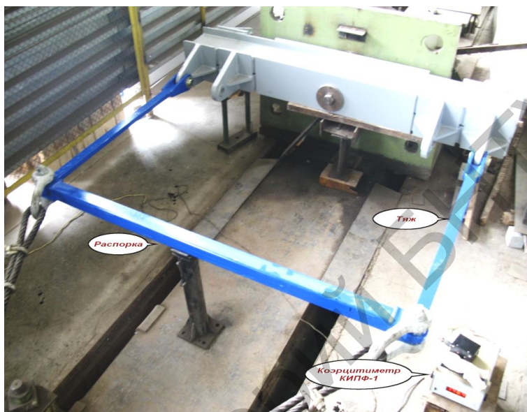
Рисунок 1 – Вид стержневой конструкции в составе испытательного стенда
