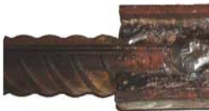
Рис. 3. Стыковое горизонтальное соединение (тип «С15-Рс»)
