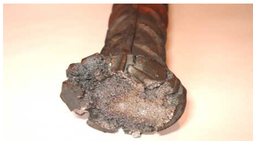
Рис. 6. Соединения типа С1-Ко после испытаний (брак)
