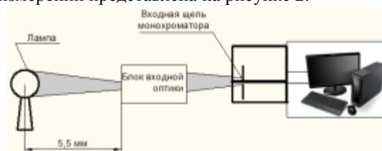
Рисунок 2 – Схема измерений СПЭО дейтериевой лампы
