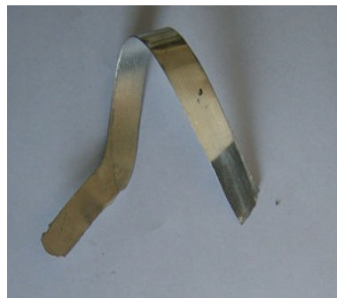
Рисунок 2 – Общий вид лигатуры на основе олова: а – экструзии; б – прокатки
