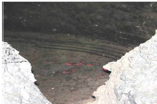
Рис. 5. Состояние рабочей футеровки опытной подины № 4 при стойкости 435 плавков
