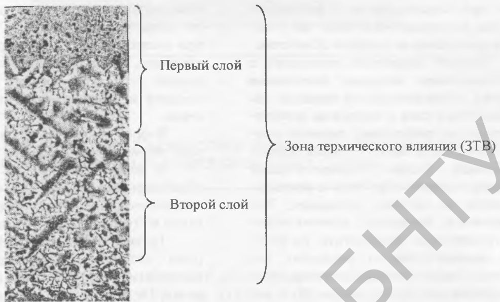
Рис. 1. Микроструктура чугуна после обработки непрерывным \text{CO}_2 -лазером ( \times 300 )
