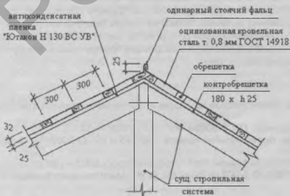
Рис. 7. Конструкция кровли чердака Софийского собора
