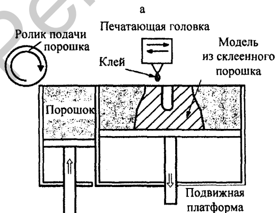
Рис. 3. Принцип работы установки для трехмерной печати (а) и образец изделия (б)
