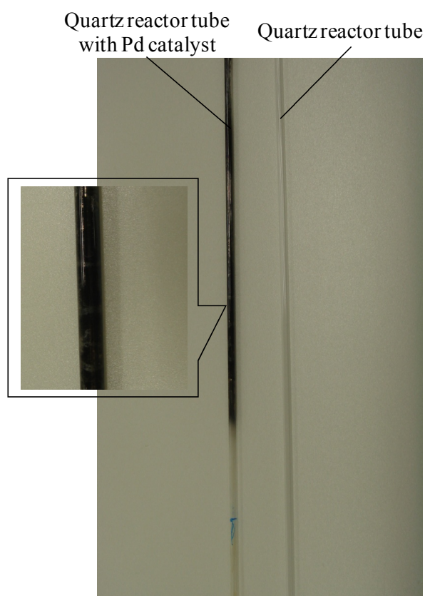
図 4.30 パラジウムを固定化した石英製反応管
