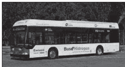
Fig. 7. Autobús de pila de combustible model Citaro Mercedes Benz O530 de l'empresa TMB, de 225 kW de potència
