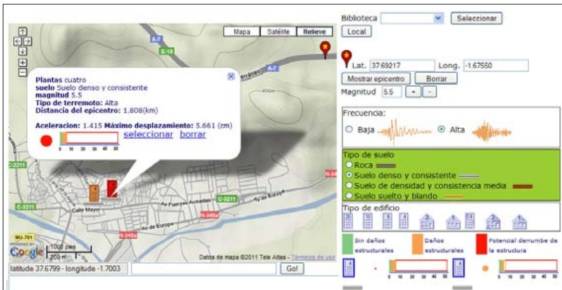
Fig. 5. Ejemplo de la simulación de un terremoto en la ciudad de Lorca.
