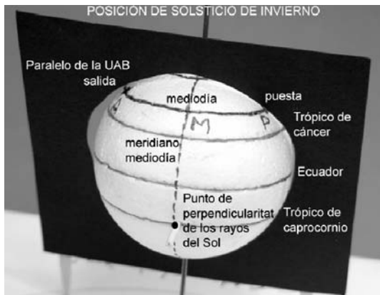
Fig. 8. Ejemplo de situación de los puntos de salida, mediodía y puesta de Sol en una posición y paralelo determinado.
