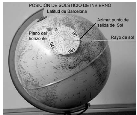
Fig. 11. Ejemplo medición del azimut de la salida del Sol en la posición de solsticio de invierno, para la latitud de Barcelona.
