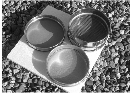
La separación de muestras de microfósiles suele requerir el empleo de tamices de distintos diámetros de malla.
