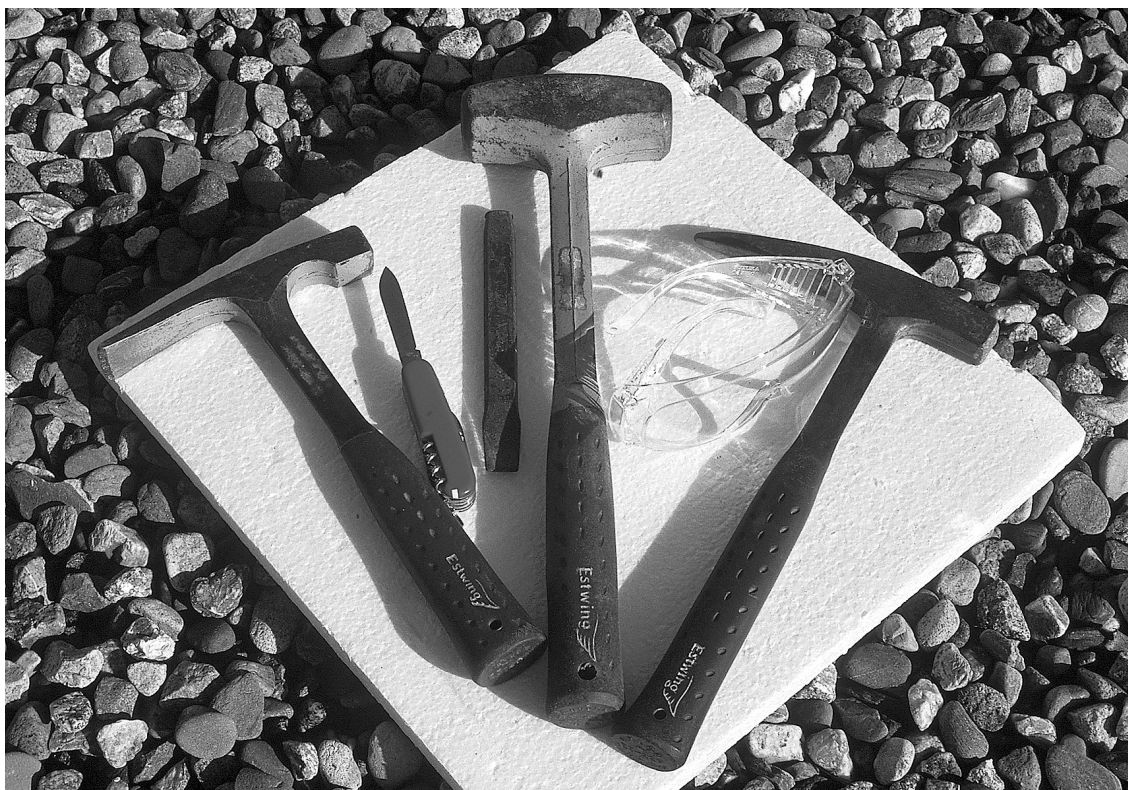
Las herramientas más utilizadas para separar los fósiles de las rocas son los martillos (de punta aguda para materiales rígidos y de punta plana para materiales blandos), la maza, los cincelos y la navaja. Es muy importante disponer de gafas de seguridad para proteger los ojos de las posibles esquirlas desprendidas en los impactos del martillo contra las rocas.
