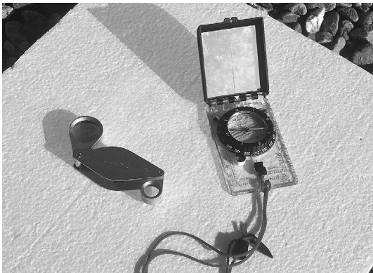
Una lupa de bolsillo de 8 a 20 aumentos permite observar ciertos detalles de las muestras. La brújula resulta imprescindible para obtener las medidas de la orientación de los estratos.
