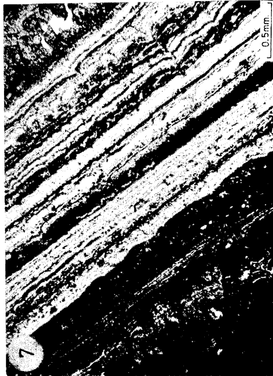
Fot. 5.-Crecimiento continuo de calcita en finas láminas paralelas con impregnaciones de óxidos de hierro. Polarizadores cruzados. Fot. 6.-Secuencia rítmica en el depósito de calcita y óxidos de hierro. Polarizadores cruzados. Fot. 7.-Alternancia de bandas ricas en óxidos de hierro y otras en calcita. Polarizadores cruzados. Fot. 8.-Diseminación de óxidos de hierro y manganeso en los intersticios del travertino. Polarizadores cruzados.
