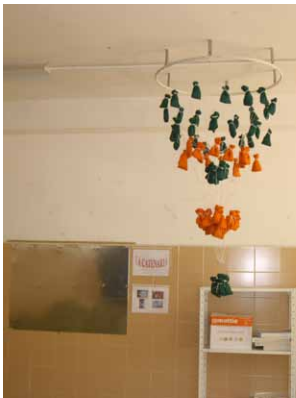
Imatge 10: espai catenari i maqueta invertida.
